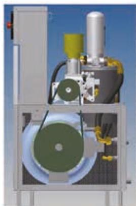
Tension automatique de la courroie
