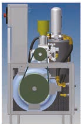
Sistema de tensado automático de la correa
