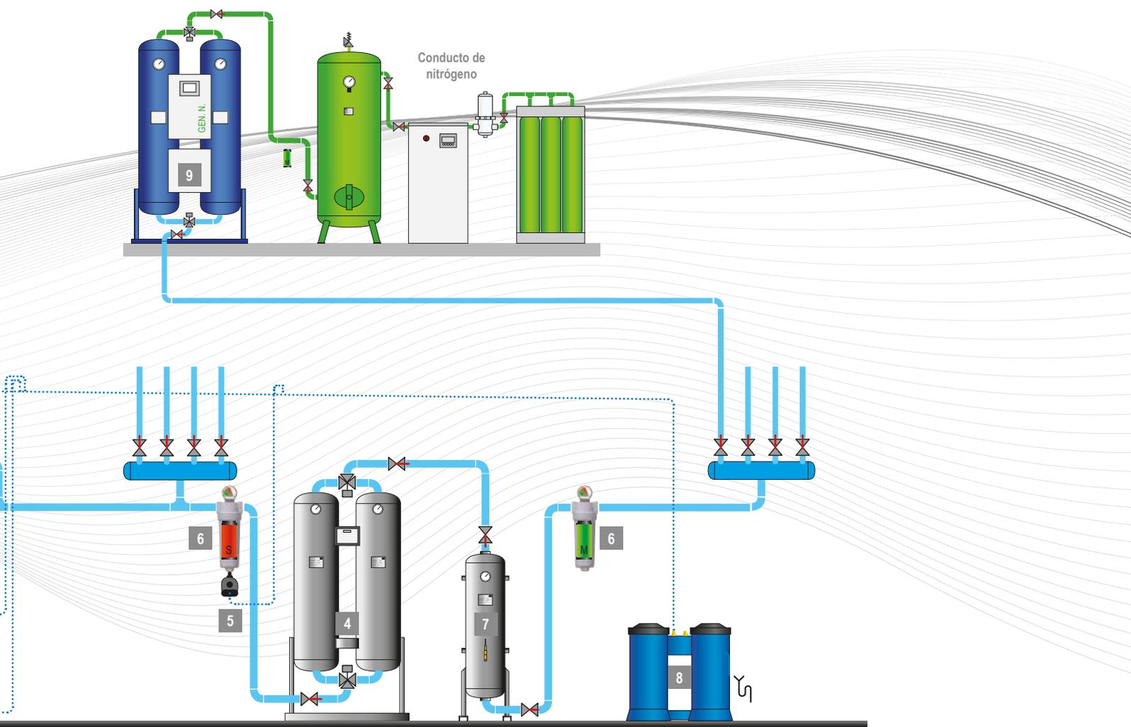
**5. Drenaje de condensado:** Se necesitan drenajes en todos los separadores, filtros, secadores y receptores para eliminar el condensado líquido del sistema de aire comprimido.
