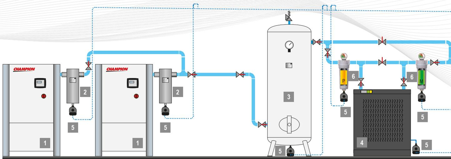
**1. Compresor:** El principio básico de funcionamiento de un compresor de aire es la compresión de aire atmosférico que se utiliza posteriormente conforme a las necesidades. En el proceso, el aire atmosférico entra por una válvula de admisión; cada vez se introduce más aire en un espacio limitado mecánicamente por medio de un pistón, una turbina o una paleta.
